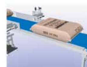
サイド面に日付やロットを印字 凸凹をバネで吸収して印字
