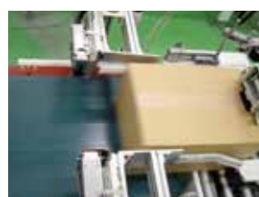
トレーサビリティ情報を上位から LAN経由で受信し印字
