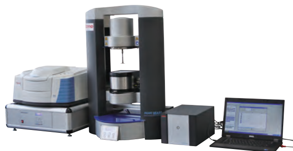
装着例：FTIR/ハイブリッド分析システム レオロジーとFTIRの複合分析
