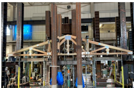
在来軸組構法用の構造製材を使用した 国産杉ネイルプレートトラスの開発
